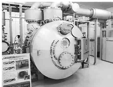
国内唯一の防振性試験評価装置 (試験品の動作や発熱により誘爆しないことを評価する)
