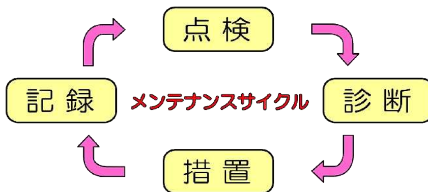
図-2 トンネルのメンテナンスサイクル
